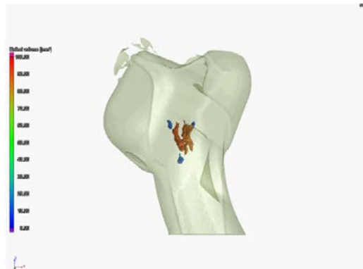
3D-Visualisierung einer innenliegenden Ungänze
