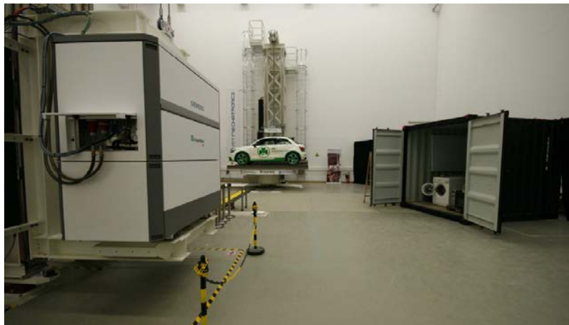
Aufbau zur CT-Messung eines fahrbereiten PKW
