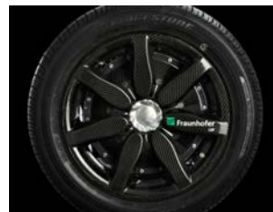
Leichtbaurad aus faserverstärkten Kunststoffen
