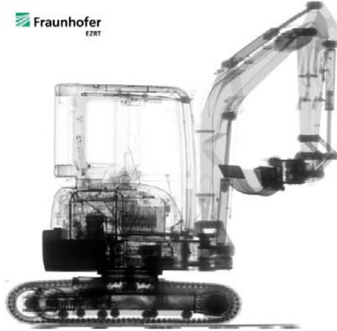
Radioskopie eines Baggers
