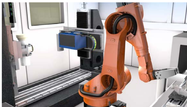
Röntgenprüfung von Fahrwerksteilen in der Bewegung
