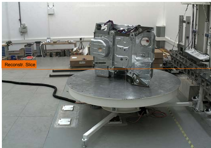
Messaufbau zur CT eines PKW-Hinterwagens
